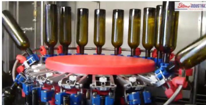
Exemple d'insuffleuse *STONE industrie*, cadence de 2 500 à 20 000 bouteilles/h
